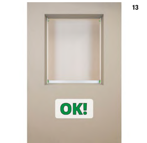
Sgrassare e asciugare la superficie di fissaggio prima di incollare il biadesivo: la completa adesione si ottiene dopo almeno 24 ore.
