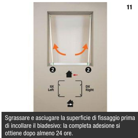
Inserire i gruppi di spinta nei profili cassa. Fare attenzione alla posizione delle guide
