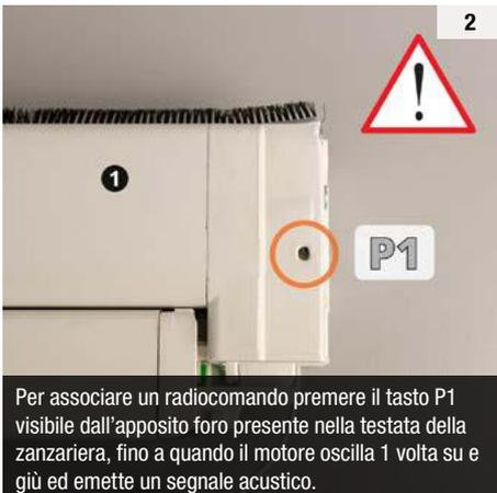
Per associare un radiocomando premere il tasto P1 visibile dall'apposito foro presente nella testata della zanzariera, fino a quando il motore oscilla 1 volta su e giù ed emette un segnale acustico.
