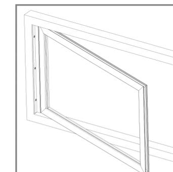
**10** (Solo per la versione con compensatore) Inserire il telaio nel compensatore fissato come illustrato nel punto 9. Infilare il secondo compensatore sul lato opposto del telaio e inserire il tutto nel vano. Forare e fissare il secondo profilo al vano.
