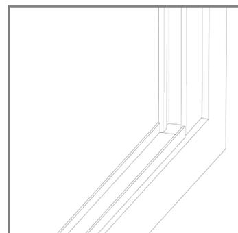
**8** (Solo per la versione a guida bassa) Fissare il binario al vano in corrispondenza dei profili laterali.
