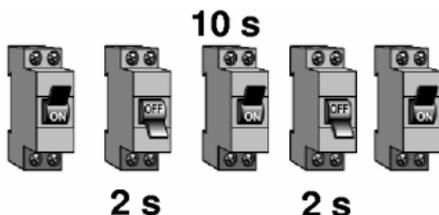
Se il telo si trova in posizione di finecorsa(alto o basso) il motore si muoverà "su e giù"; in una qualsiasi altra posizione il telo si muoverà per 5 sec.(in salita oppure in discesa).
