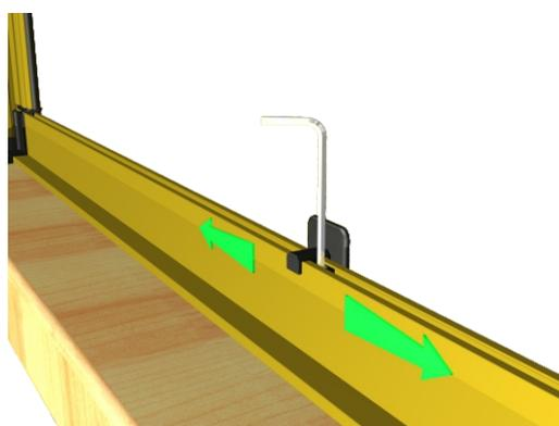
**Posizionare il ferma anta inferiore e fissarlo**
