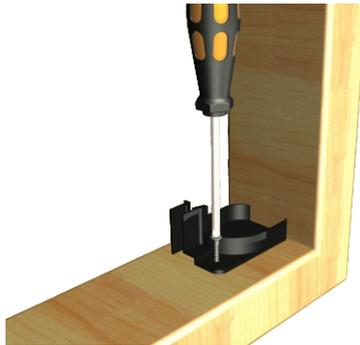
**Fissare un supporto nel vano**
