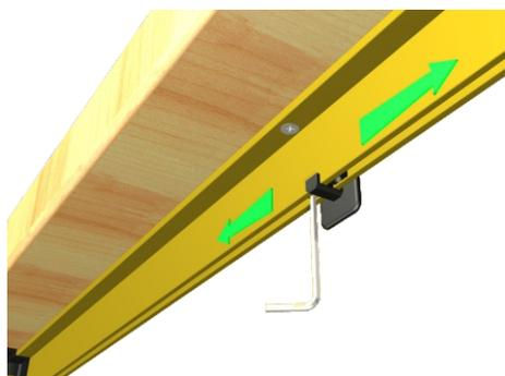
**Portare il ferma anta al centro delle guide tagliate e fissarlo (il ferma anta con dotazioni di due fori per i grani terrà fissato il pezzo di guida non ancorato al vano)**
