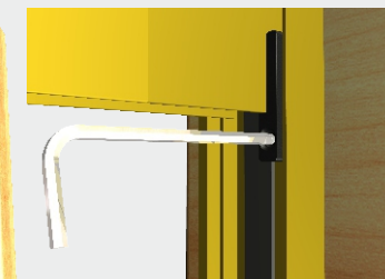
Inserire le guide tra la sede predisposta delle piastre( NB fare attenzione che le ruote non entrano nella sede inferiore Fig. A) e il profilo di chiusura e portarle a contatto con il vano, portare in posizione i ferma guide e bloccarli tramite il grano m5x10 con una chiave a brugola.
