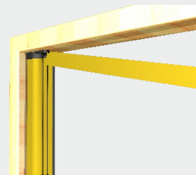
Inserire le guide tra la sede predisposta delle piastre( NB fare attenzione che le ruote non entrano nella sede inferiore Fig. A) e il profilo di chiusura e portarle a contatto con il vano, portare in posizione i ferma guide e bloccarli tramite il grano m5x10 con una chiave a brugola.
