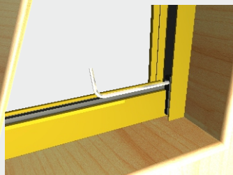
Inserire le guide tra la sede predisposta delle piastre( NB fare attenzione che le ruote non entrano nella sede inferiore Fig. A) e il profilo di chiusura e portarle a contatto con il vano, portare in posizione i ferma guide e bloccarli tramite il grano m5x10 con una chiave a brugola.
