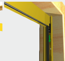
Inserire le guide tra la sede predisposta delle piastre( NB fare attenzione che le ruote non entrano nella sede inferiore Fig. A) e il profilo di chiusura e portarle a contatto con il vano, portare in posizione i ferma guide e bloccarli tramite il grano m5x10 con una chiave a brugola.
