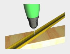
Profilo di chiusura: Praticare n 3 fori per il fissaggio n. 2 a circa 30 cm dalle due estremità e n.1 centrale.
