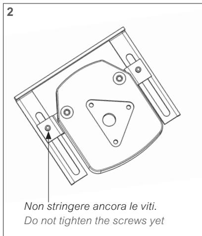
Fissare il supporto alla testa del motore come in figura.
