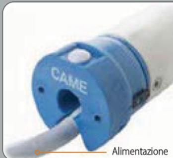
Motore a comando filare 230 V AC - 50 Hz. Finecorsa elettronico via cavo. Protezione del motore in caso di blocco dell'azione di avvolgimento dovuto ad ostacolo o altro impedimento meccanico. Regolazione facile del finecorsa tramite pulsante sulla testa (esclusa Moovicaincasso) o con accessorio per la programmazione (optional). Grado di protezione: IP44
