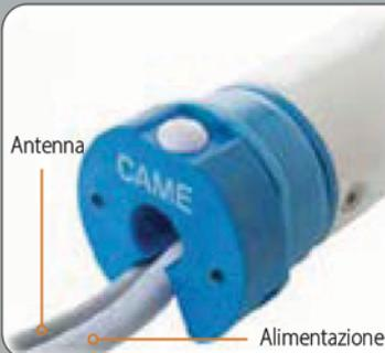
Motore 230 V AC - 50 Hz a comando via radio con ricevitore 433.92 MHz integrato. Finecorsa elettronico. Protezione del motore in caso di blocco dell'azione di avvolgimento dovuto ad ostacolo o altro impedimento meccanico. Possibilità di regolazione del punto di finecorsa intermedio (apertura parziale). L'antenna deve rimanere all'esterno. Grado di protezione: IP44
